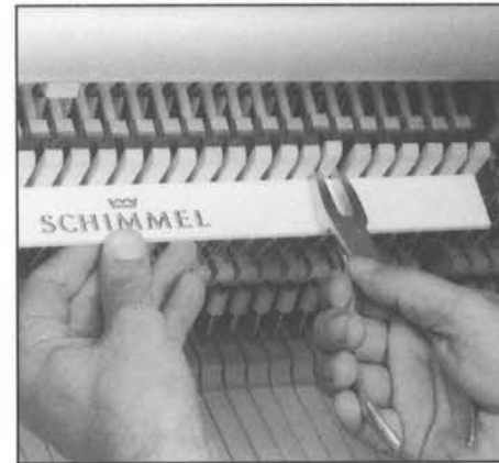
Abb. 100 Parallele Ausrichtung der hinteren Flächen der Fängerköpfe.
