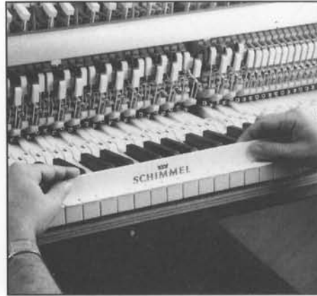
Abb. 54 Prüfung der Höhenlage der Tasten zueinander.
