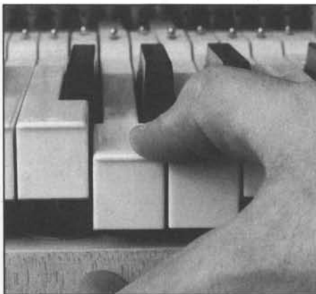
Abb. 108 Beweglichkeitskontrolle der Dämpferkapselteile.
