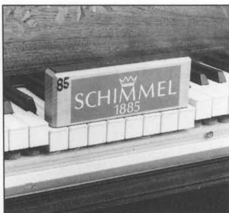
Abb. 124 Prüfgewicht für Tastengruppe (dynamisches Minimalgewicht).
