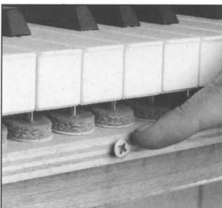
Abb. 119 Distanz- und Stützschraube zur Sicherung des Abstandes zwischen Stuhlbodenleisten und Tastenfront.
