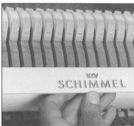
Abb. 76 In Ruheposition sollen die Hammerköpfe an ihrem hinteren Ende eine gerade Linie bilden.
