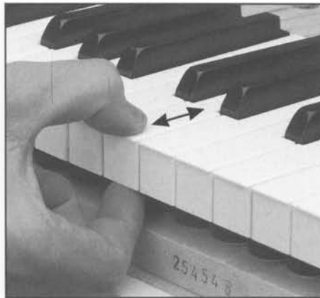
Abb. 42 Prüfung des Tastenlagers in Längsrichtung der Taste.
