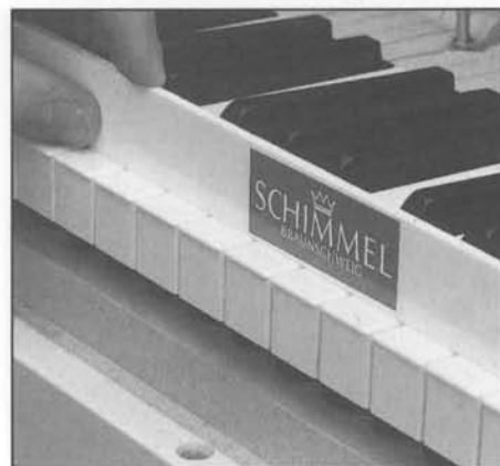
Abb. 51 Prüfung der horizontalen Ausrichtung der weißen Tasten untereinander.
