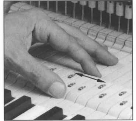
Abb. 38 Beweglichkeitsprüfung der Stiftführung am Waagebalken.
