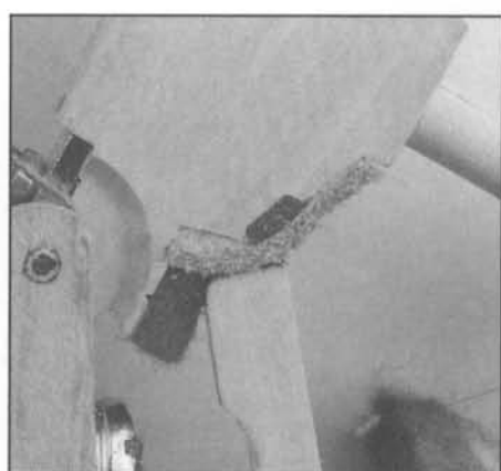
Abb. 80 Korrekte Stellung der Stoßzunge unter der Hammernuß.
