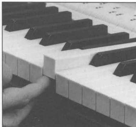
Abb. 43 Im optimalen Fall bewegen sich vorn leicht angehobene Tasten langsam in ihre Ruheposition zurück.
