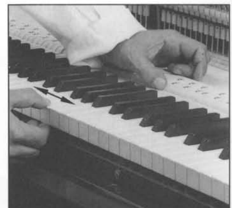
Abb. 34 Beweglichkeitsprüfung am Vorderstift der Taste unter gleichzeitiger Stabilisierung der Taste am Waagebalken.
