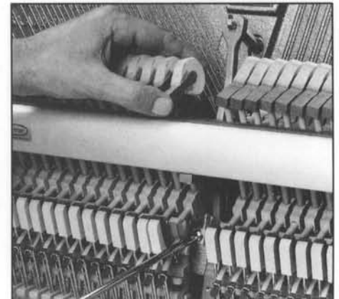
Abb. 62 Leichtes, seitliches Verschieben eines Hammerkopfes bei gelöster Hammernußkapselschraube und Wiederbefestigung in korrekter Position.
