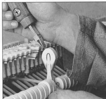
Abb. 15 Grundintonation eines Hammerkopfes im Bereich der Mezzofortezone.
