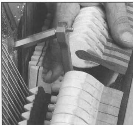
Abb. 93 Bei getretenem Pedal sollen sich die ausgehobenen Dämpferköpfe noch 2 bis 3 mm bewegen lassen.
