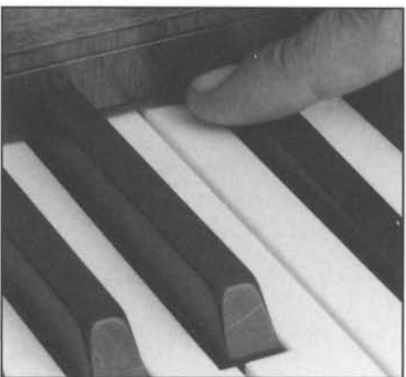
Abb. 118b Der Garnierfilz am hinteren Ende der schwarzen Tasten darf an keiner Stelle umgeknickt sein.
