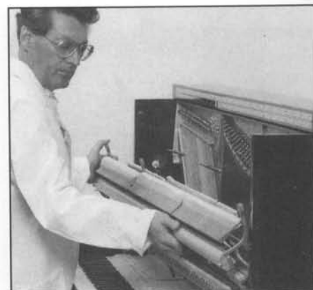
Abb. 19 ... in der hier abgebildeten Weise kann die Mechanik aus dem Instrument herausgehoben werden.
