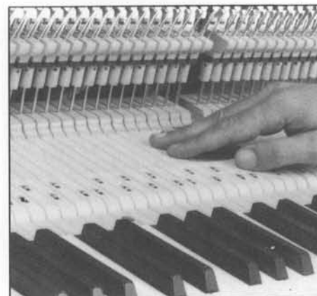
Abb. 84 Mangelnde Schnabelluft führt zur Unruhe der Hammerkopflinie, wenn direkt vor der Mechanik mit leichtem Druck über die Tasten gestrichen wird.
