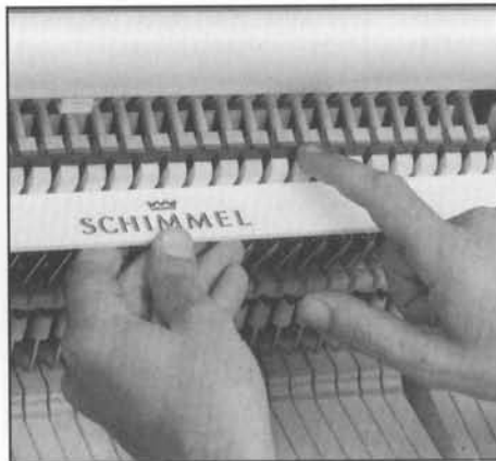
Abb. 106 Ausrichten der Fängerköpfe in eine gerade Linie durch Biegedruck mit dem Finger oder mit der Schnabelzange (Abb. 100).
