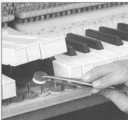
Abb. 96 Korrektur von Spieltiefe und Nachdruckgefühl durch Einfügen oder Entfernen von Papierfläckchen unter den Filzscheiben.
