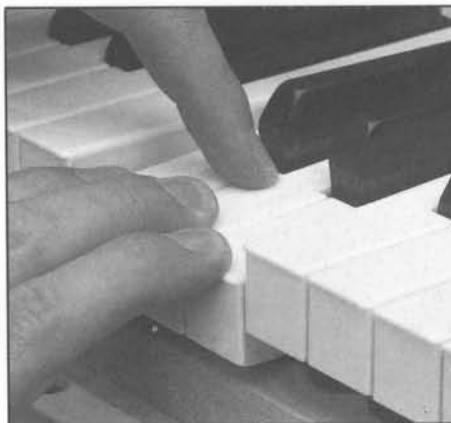
Abb. 98 Gefühlsmäßige Kontrolle von jeweils 3 Tasten (gleichmäßiger Tiefgang).
