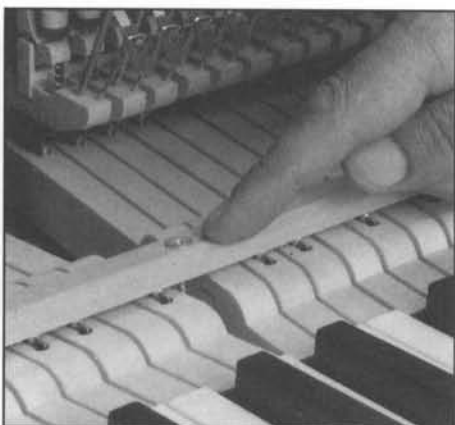
Abb. 118a Tastatur mit separater Tastenstoppleiste.
