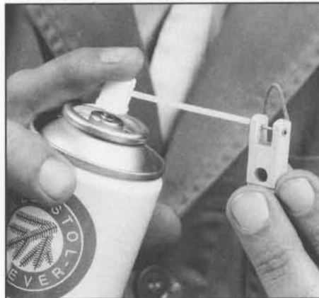
Abb. 28 Sorgfältige Zuführung einer minimalen Menge von Gewehröl als Gleitmittel für den Achsstift.
