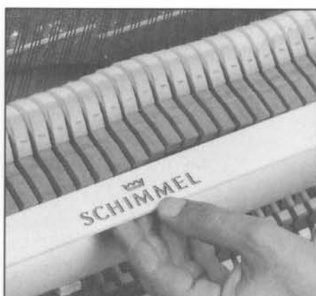
Abb. 77 Eine ungleiche Ruheposition liegt an fehlender Schnabelluft oder einer Veränderung des Hammerleistenpolsters.
