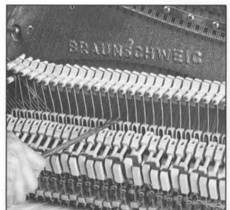
Abb. 87 Seitliche Positionskorrekturen erfolgen unmittelbar über der Dämpfertangente und ...
