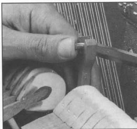
Abb. 18 Nach Entfernung der Sicherungsschrauben werden die Mechanikstützen von den drei Mechanikbolzen gelöst. Dann wird die Mechanik leicht nach hinten gekippt und ...
