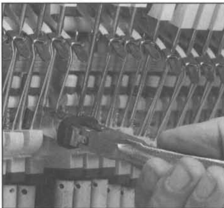
Abb. 102 Seitliche Positionskorrektur eines Fängerkopfes am unteren Drahtende und ...
