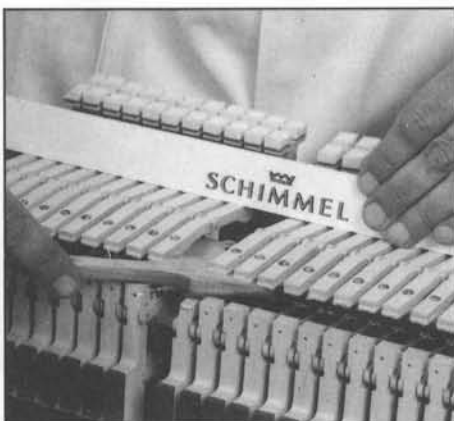
Abb. 22 Zum Einfetten der Abhebestange eignet sich eine Mischung aus Graphit und Hirschtalg.
