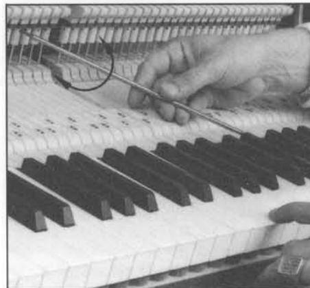
Abb. 83 Einstellung der Schnabelluft an den Pilotenschrauben.
