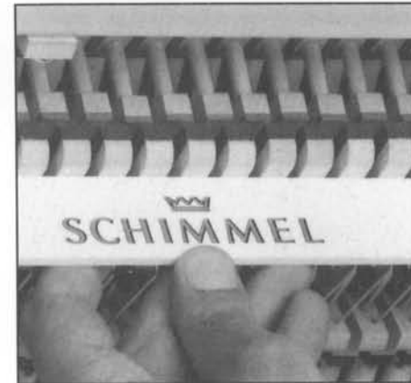
Abb. 101 Korrekte, parallele und in gerader Linie ausgerichtete Fängerköpfe.
