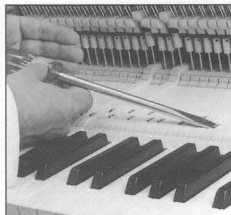
Abb. 52 Korrektur der horizontalen Position der Tasten zueinander.
