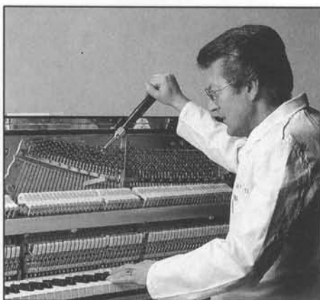
Abb. 17 Korrekte Sitzposition und sichere Stimmhammerführung sind wichtig beim Stimmen der Instrumente.
