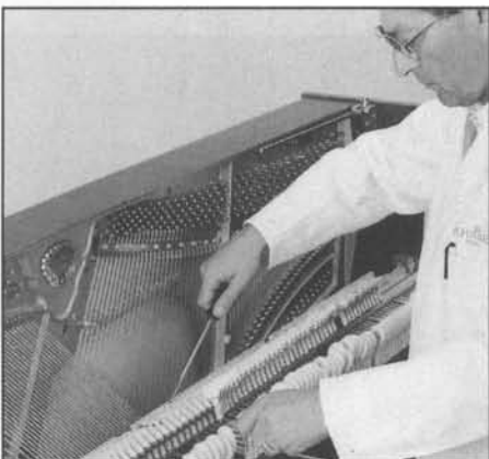
Abb. 89a Bei herausgeklappter Mechanik sind die Dämpferlöffel mit einem Kröpfisen zugänglich und ...
