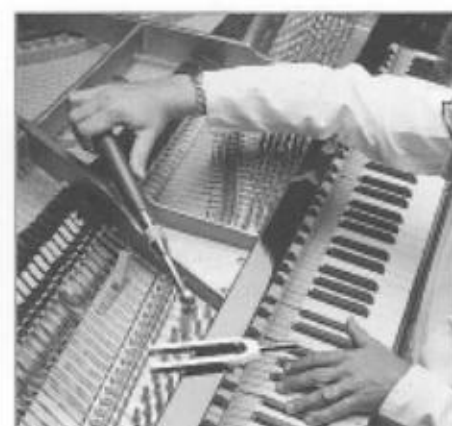
Abb. 17d Korrekte Sitzposition und sichere Stimmhammerführung sind wichtig beim Stimmen der Instrumente.
