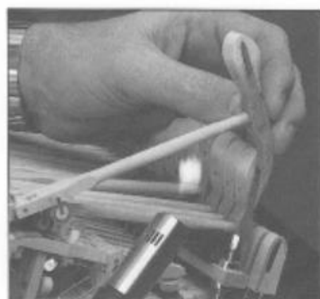
Abb. 58 Korrektur der schrägen Hammerkopfstellung durch Erwärmen des Hammerstiels und Drehen.
