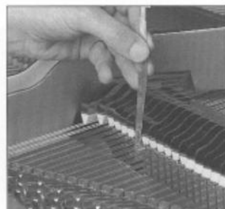
Abb. 87b Prüfung der Höhenposition der Hammerköpfe in ihrer unteren Ruhestellung.
