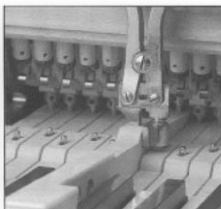
Abb. 46 So wird die Beweglichkeit mit einer Zange erweitert ...
