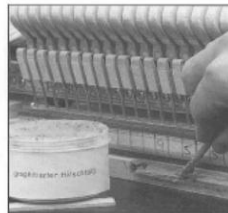
Abb. 25 Hirschtalg mit Graphit als Gleitmittel.
