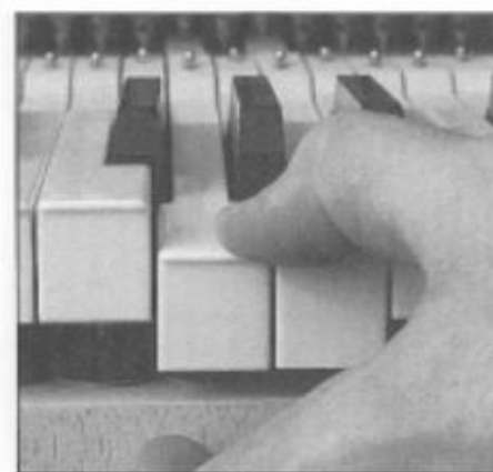
Abb. 106 Kontrolle des Nachdruckes durch gefühlovolles Niederdrücken einzelner oder von 2 benachbarten Tasten bis an den Druckpunkt.
