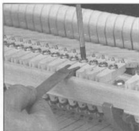
Abb. 64 Ausrichten und Spatiumkorrektur der Hammerköpfe.
