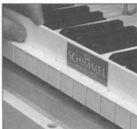
Abb. 76 Prüfung der Höhenlage der Tasten zueinander.
