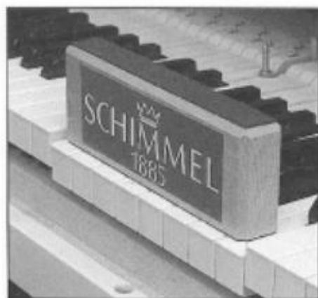
Abb. 124 Prüfgewicht für Tastengruppe (dynamisches Minimalgewicht).
