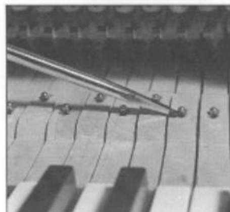
Abb. 74 Korrektur der Stellung seitlich abgekloppter Tasten.
