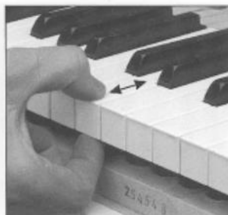
Abb. 49 Prüfung des Tastenlagers in Längsrichtung der Taste.
