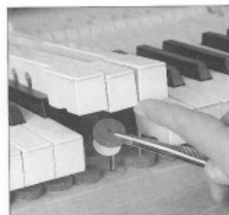
Abb. 91 Einfügen dünner Papierscheiben.
