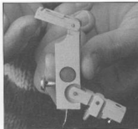
Abb. 108 Beweglichkeitskontrolle der Dämpferkapselteile.
