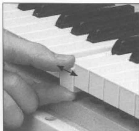
Abb. 39 Beweglichkeitsprüfung am Vorderstift ...
