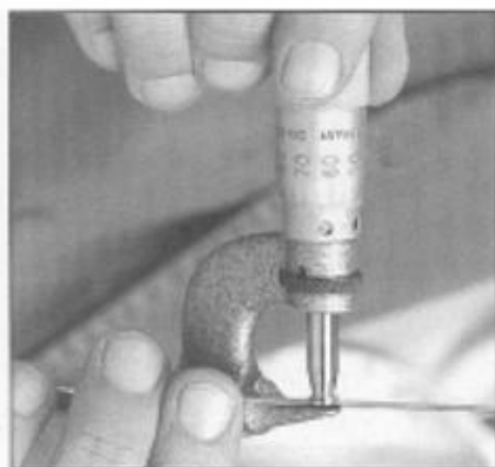
Abb. 33a Nach dem Messen der ausgestoßenen Achse wird der richtige, etwas stärkere Achsdraht bzw. Achsstift ausgewählt.
