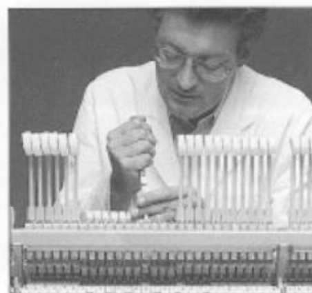
Abb. 17a Beim Intonieren ...
