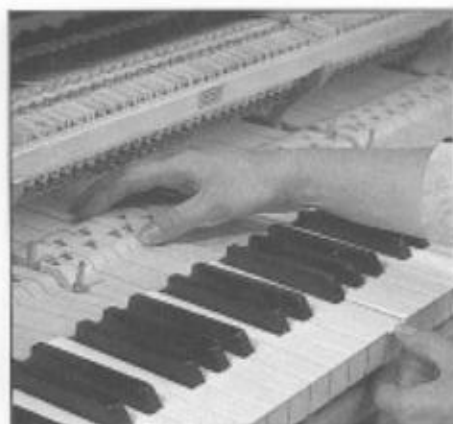
Abb. 40 ... unter Stabilisierung der Taste am Waagebalken.
