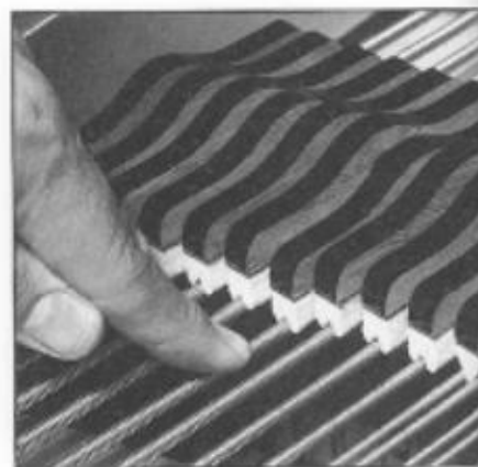
Abb. 126 Kontrollmaßnahme für Dämpfersitz auf Baßsaiten. Die Dämpferköpfe sollen dem Niederdrücken der Saiten ca. 3 mm folgen.
