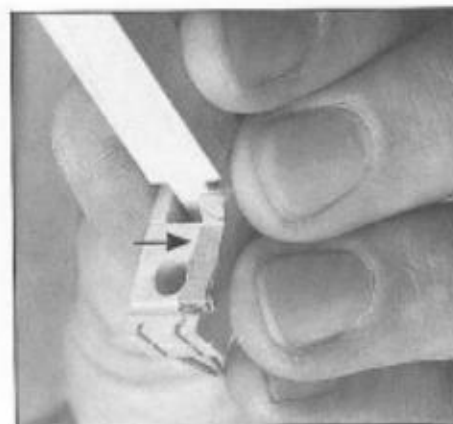
Abb. 81 Seitliche Korrektur des Hebegliedes nach rechts durch Papierstreifen auf rechter Kapselhälfte (Blickrichtung von vorn).
