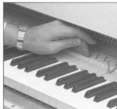
Abb. 23 Klopfkontrolle am Waagebalken mit aufgeschraubtem Spielwerk.
