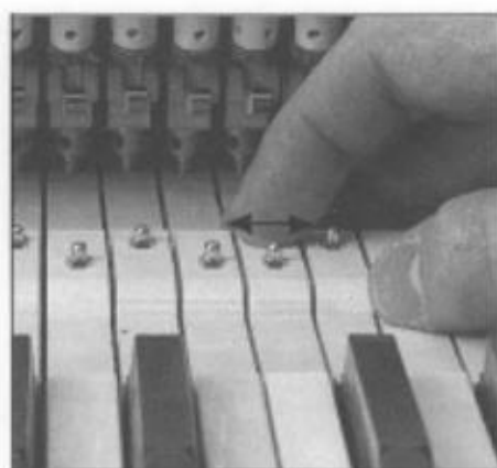
Abb. 45 Beweglichkeitsprüfung der Stiftführung am Waagebalken.
