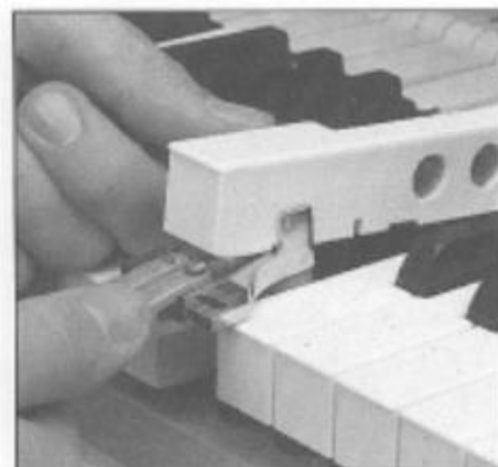
Abb. 41 So wird die Beweglichkeit mit einer Zange feinfühlig erweitert, bzw. ...
