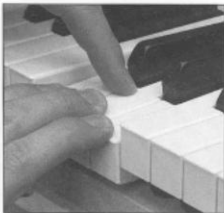
Abb. 94 Gefühlsmäßige Kontrolle von jeweils 3 Tasten (gleichmäßiger Tiefgang).
