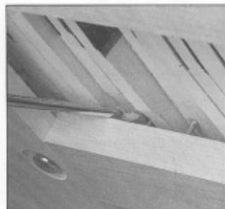
Abb. 75 Einfügen (höhere Tastenlage) oder Entfernen (tiefere Tastenlage) einzelner Waagebalkenfleckchen bei aufgeschraubter Mechanik.
