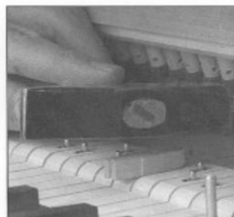
Abb. 77 Geringfügige Korrektur zu hoch liegender Tasten durch leichtes Klopfen.
