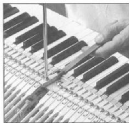
Abb. 67 Ausrichten der Hammerköpfe auf die Klangsaiten.
